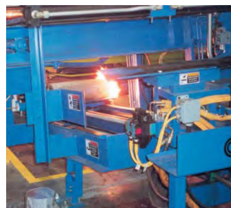
С помощью экструзии “Эликсир” изготавливает широкий ассортимент заказных алюминиевых профилей. Здесь алюминиевая болванка раскаляется до температуры 520 градусов, чтобы сделать металл более гибким для экструзии.
