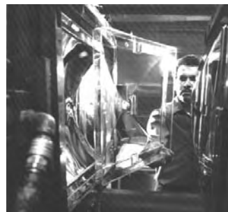
Рамы вентиляционных отверстий (изображены выше) и вкладыши для холодильных камер изготавливаются с помощью плавления пластиковых зёрнышек, впрыскивания жидкости в форму и ее последующего охлаждения.
