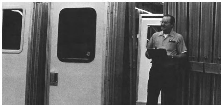
Входные двери рекреационных автомобилей (примерно 1979 года) изготавливаются так, чтобы они были стойкими к вибрации. Шарниры выполнены по всей длине двери для обеспечения прочности, а также непрерывного и однородного уплотнения.
