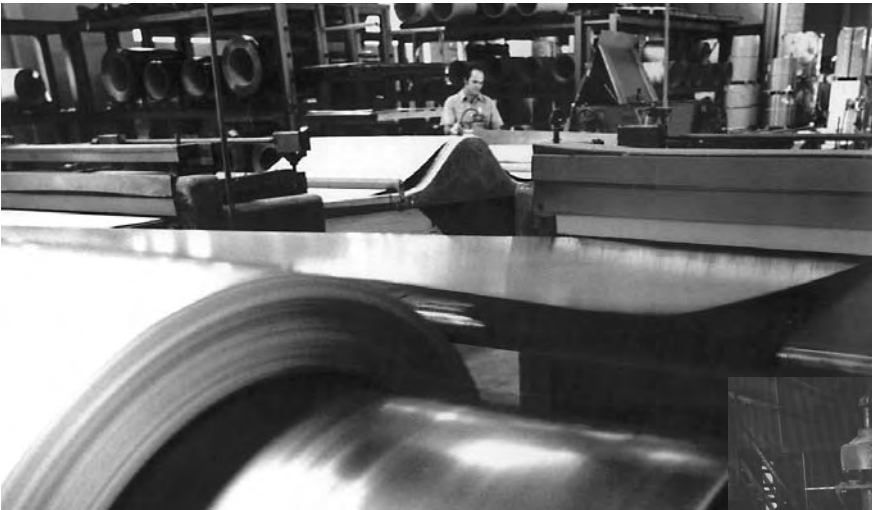
Рулоны алюминия используются для наружной обшивки и кровли рекреационных автомобилей и жилых трейлеров. Сталь применяется для изготовления конструктивных элементов жилых трейлеров и других конструкций.
